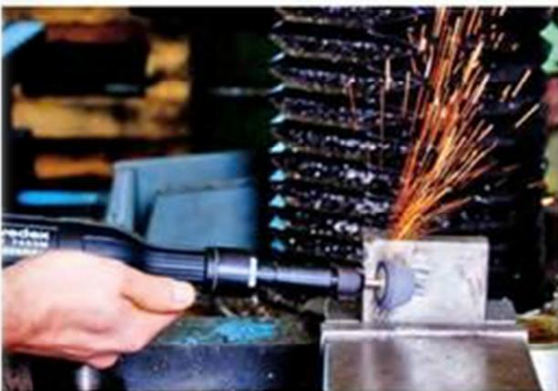
und mit dem verlängerten Schaft auch an eine gute Erreichbarkeit schwer zugänglicher Stellen gedacht. Ein Sicherheitshebel schützt vor unbeabsichtigtem Einschalten, und die Abluft verlässt den Schaft in seitlicher Richtung. Der Anwender kann die Spannzangen austauschen und daher verschiedenartige Schleifkörper einsetzen. *pb*
