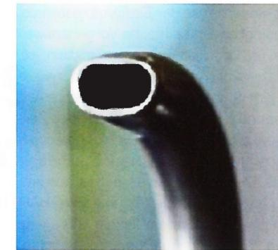
**Bild 2:** Eine häufig in der Industrie zu findende, aber meist ineffiziente Druckluftanwendung sind offene Rohre.
